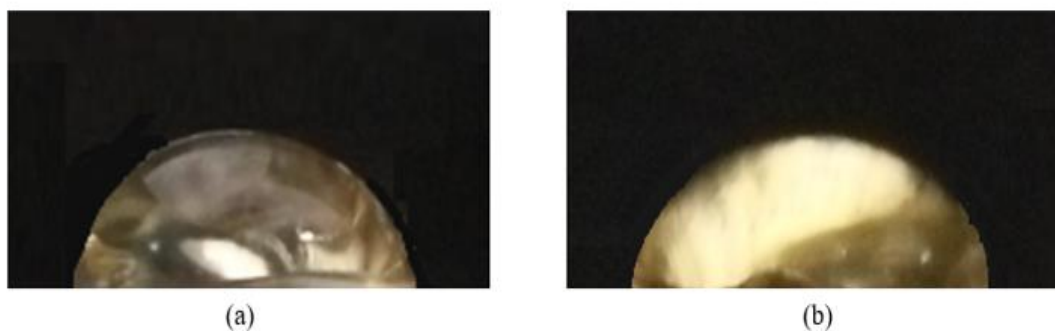
Gambar 3. Image droplet air di atas permukaan membran Cs (a), CC (b)
